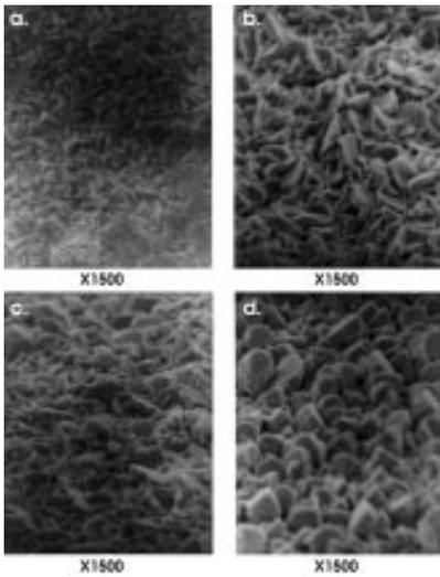
Fig. 2—SEM photographs for pure Zn coatings at: (a) 100 mA/cm<sup>2</sup>; (b) 200 mA/cm<sup>2</sup>; (c) 400 mA/cm<sup>2</sup>; (d) 600 mA/cm<sup>2</sup>.
